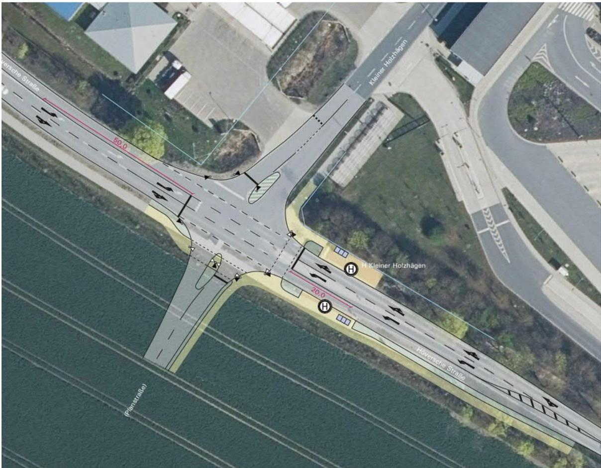
Abb. 28 Entwurf Variante I: Signalisierter Knotenpunkt
