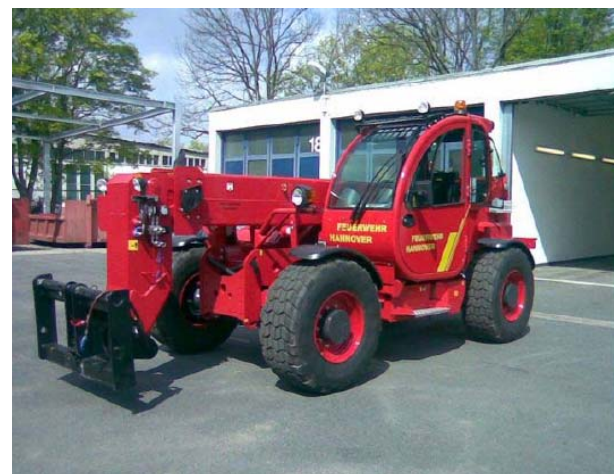
Teleskoplader zum schnellen Umschlagen von Logistikgütern der Feuerwehr (z.B. Schaummittel, Sandsäcke) (Foto: Feuerwehr Hannover)
