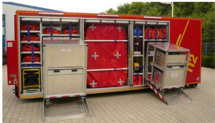
Abrollbehälter Hochwasserschutzsysteme der Feuer- und Rettungswache 4 (Foto: Feuerwehr Hannover)
