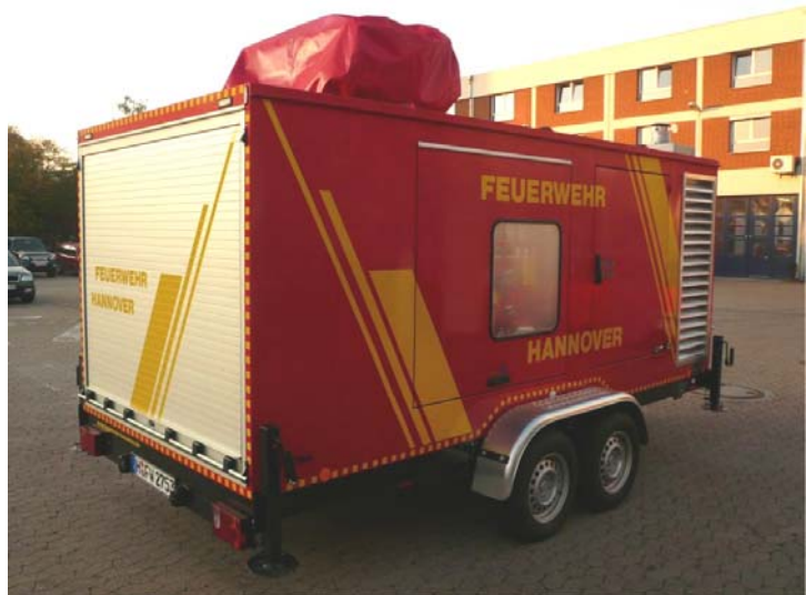
Anhänger Notstromversorgung der Ortsfeuerwehr Anderten (Foto: Feuerwehr Hannover)
