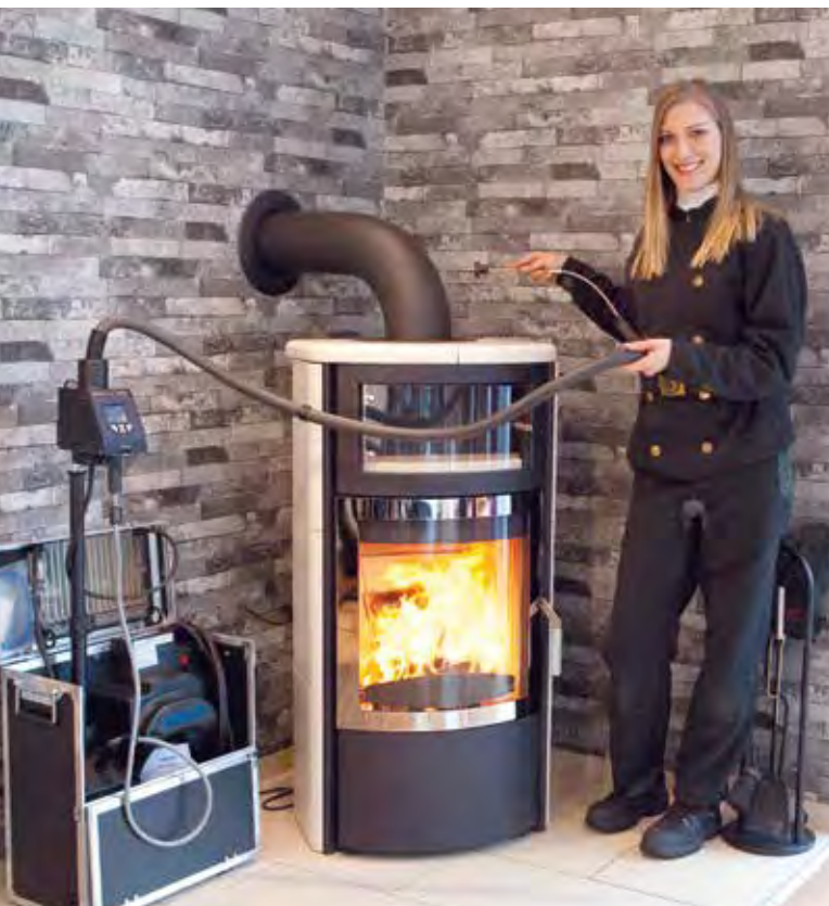
Staubmessung an einem Kaminofen
